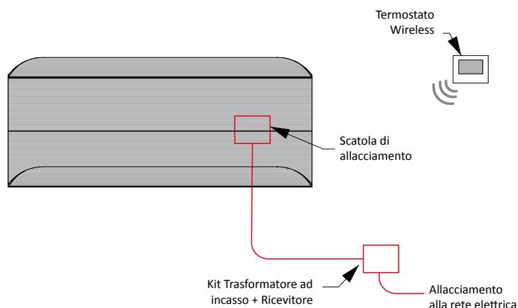
Allacciamento mediante Termostato Wireless
