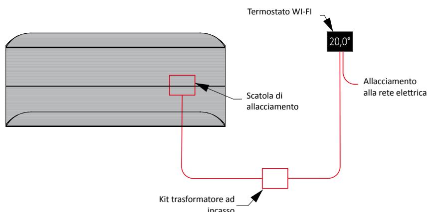
Allacciamento mediante Termostato WI-FI
